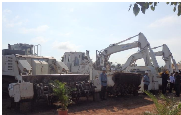
写真-2 視察した地雷除去機
